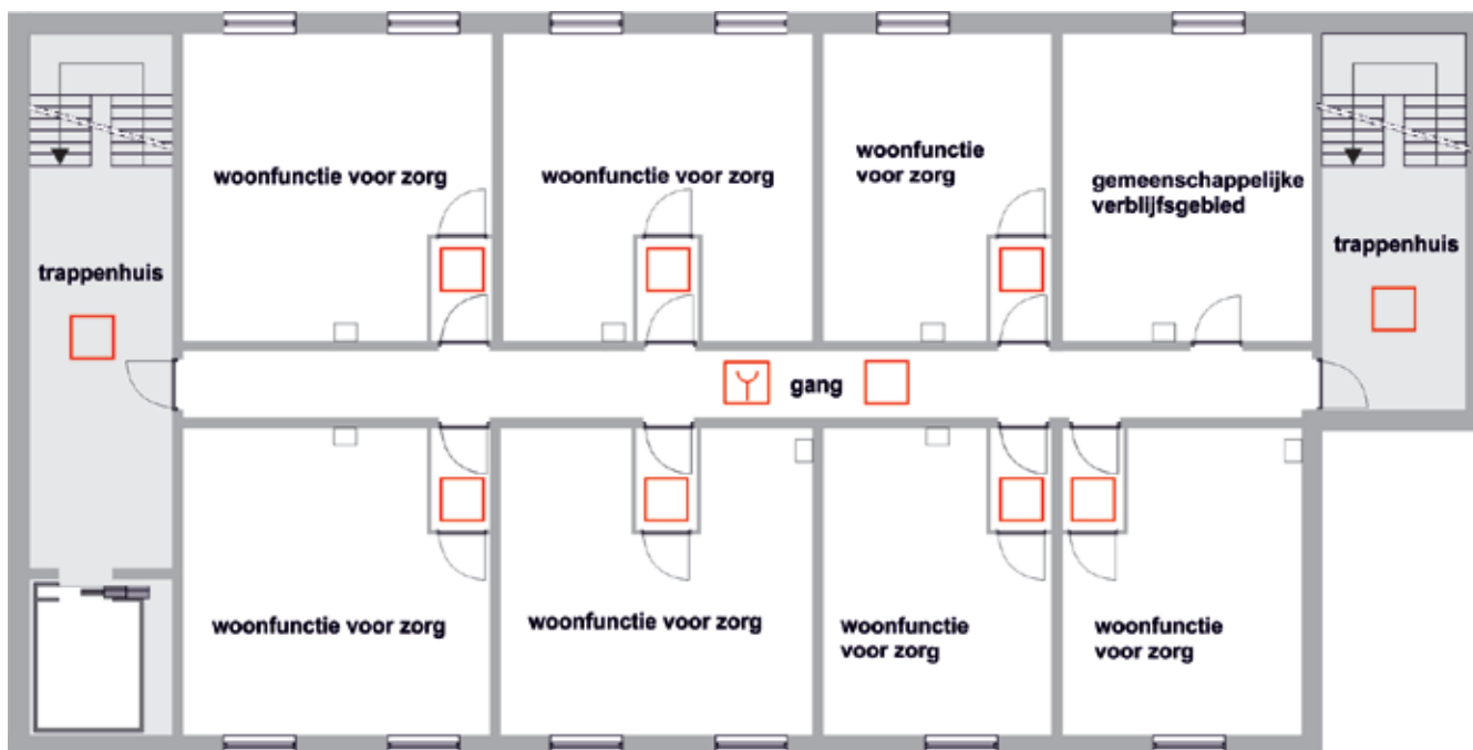
Figuur 13: Brandmeldinstallatie met gedeeltelijke bewaking in een woongebouw met zorgclusterwoningen voor zorg op afroep
